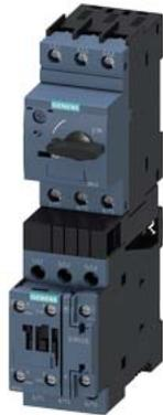
partenza senza fusibili, avviamento diretto AC 400 V, grandezza costruttiva S0 13 ... 20 A DC 24 V morsetti a vite per montaggio su guida DIN (conformemente anche al tipo di coordinamento 1) tipo di coordinamento 2, I<sub>q</sub> = 150 kA 1 NO+1 NC (contattore)
