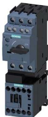
partenza senza fusibili, avviamento diretto AC 400 V, grandezza costruttiva S00 4,50 ... 6,30 A DC 24 V morsetti a vite per montaggio su guida DIN (conformemente anche al tipo di coordinamento 1) tipo di coordinamento 2, I<sub>q</sub> = 150 kA 1 NC (contattore) 1 NO+1 NC (interruttori automatici, trasversali)
