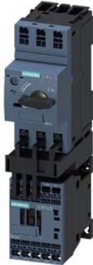
partenza senza fusibili, avviamento diretto AC 400 V, grandezza costruttiva S00 10 ... 16 A AC 230 V morsetti a molla per montaggio su guida DIN tipo di coordinamento 1, I<sub>q</sub> = 150 kA 1 NO (contattore)
