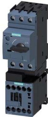
partenza senza fusibili, avviamento diretto AC 400 V, grandezza costruttiva S00 2,80 ... 4,00 A DC 24 V morsetti a vite per montaggio su guida DIN (conformemente anche al tipo di coordinamento 1) tipo di coordinamento 2, I<sub>q</sub> = 150 kA 1 NO (contattore) con diodo (integrata)
