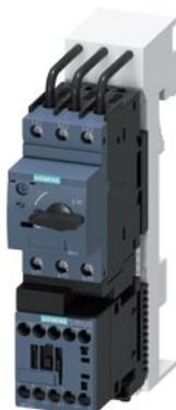
partenza senza fusibili, avviamento diretto AC 400 V, grandezza costruttiva S00 1,40 ... 2,00 A AC 230 V morsetti a vite per sistema a sbarre collettrici 60 mm (conformemente anche al tipo di coordinamento 1) tipo di coordinamento 2, I<sub>q</sub> = 150 kA 1 NO (contattore)
