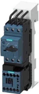
partenza senza fusibili, avviamento diretto AC 400 V, grandezza costruttiva S00 1,10 ... 1,60 A DC 24 V morsetti a vite per sistema a sbarre collettrici 60 mm (conformemente anche al tipo di coordinamento 1) tipo di coordinamento 2,  $I_q = 150 \text{ kA}$  1 NO (contattore) con diodo (integrata)
