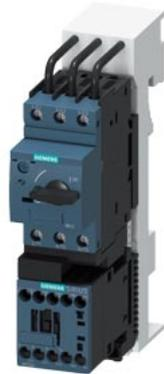
partenza senza fusibili, avviamento diretto AC 400 V, grandezza costruttiva S00 0,70 ... 1,00 A DC 24 V morsetti a vite per sistema a sbarre collettrici 60 mm (conformemente anche al tipo di coordinamento 1) tipo di coordinamento 2, I<sub>q</sub> = 150 kA 1 NO (contattore)
