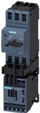
partenza senza fusibili, avviamento diretto AC 400 V, grandezza costruttiva S00 0,35 ... 0,50 A DC 24 V morsetti a molla per montaggio su guida DIN (conformemente anche al tipo di coordinamento 1) tipo di coordinamento 2,  $I_q = 150 \text{ kA}$  1 NO (contattore)
