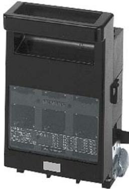
SETRON, sezionatore sottocarico a fusibili 3NP5, a 3 poli, NH00, 160 A, con Adattatore per Sistema di sbarre collettrici 8US 40mm, con inserzione rapida, morsetto a staffa, Bloccetto di contatti ausiliari su sezionatore sottocarico: 1 NO+1 NC
