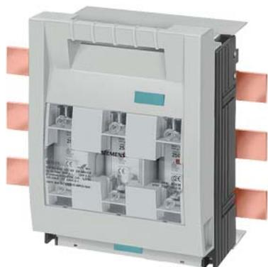
SETRON, sezionatore sottocarico a fusibili 3NP5, a 3 poli, NH00, 160 A, con Adattatore per Sistema di sbarre collettrici 8US 40mm, con inserzione rapida, morsetto a staffa
