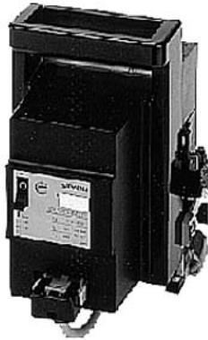
SENTRON, sezionatore sottocarico a fusibili 3NP5, a 3 poli, NH00, 160 A, per montaggio e installazione su piastra di montaggio, con inserzione rapida, morsetto a staffa, controllo fusibili: mediante 3VU, Blocchetto di contatti ausiliari su sezionatore sottocarico: 1 NO+1 NC, Blocchetto di contatti ausiliari su controllo fusibili: 1 NO+1 NC
