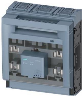
SETRON, sezionatore sottocarico a fusibili 3NP1, a 3 poli, NH3, 630 A, per montaggio e installazione su piastra di montaggio, morsetto serracavo, controllo fusibili, elettronico EFM15, livello di copertura 70mm
