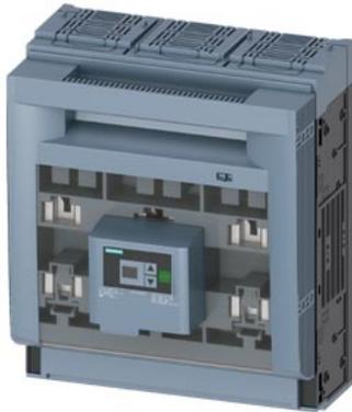
SETRON, sezionatore sottocarico a fusibili 3NP1, a 3 poli, NH3, 630 A, per montaggio e installazione su piastra di montaggio, morsetto serracavo, controllo fusibili: elettronico EFM20, livello di copertura 70mm
