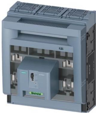
SETRON, sezionatore sottocarico a fusibili 3NP1, a 3 poli, NH3, 630 A, per montaggio e installazione su piastra di montaggio, attacco piatto, controllo fusibili: elettromeccanico, livello di copertura 70mm
