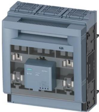
SETRON, sezionatore sottocarico a fusibili 3NP1, a 3 poli, NH3, 630 A, per sistema di sbarre collettive 8US 60mm, morsetto serracavo, controllo fusibili, elettronico EFM15, livello di copertura 32/70 mm
