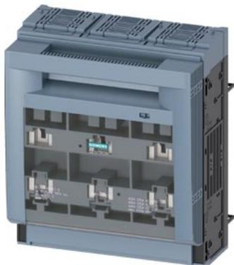
SETRON, sezionatore sottocarico a fusibili 3NP1, a 3 poli, NH3, 630 A, per Sistema di sbarre collettive 8US 60mm, attacco piatto, livello di copertura 32/70mm
