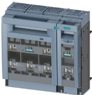
SETRON, sezionatore sottocarico a fusibili 3NP1, a 4 poli, NH2, 400 A, per sistema di sbarre collettive 8US 60mm, morsetto serracavo, livello di copertura 32/70 mm
