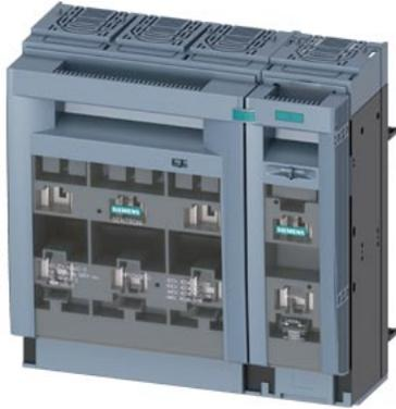
SETRON, sezionatore sottocarico a fusibili 3NP1, a 4 poli, NH2, 400 A, per sistema di sbarre collettive 8US 60mm, attacchi piatti, livello di copertura 32/70 mm
