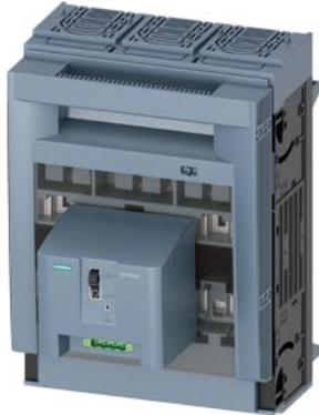
SETRON, sezionatore sottocarico a fusibili 3NP1, a 3 poli, NH2, 400 A, per Sistema di sbarre collettive Rittal 60mm, attacco piatto, controllo fusibili: elettromeccanico, livello di copertura 32/70mm
