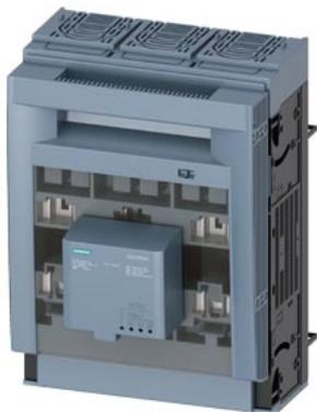
SETRON, sezionatore sottocarico a fusibili 3NP1, a 3 poli, NH2, 400 A, per Sistema di sbarre collettrici 8US 60mm, attacco piatto, controllo fusibili: elettronico EFM10, livello di copertura 32/70mm
