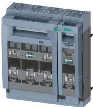
SETRON, sezionatore sottocarico a fusibili 3NP1, a 4 poli, NH1, 250 A, per sistema di sbarre collettive 8US 60mm, morsetto serracavo, livello di copertura 32/70 mm
