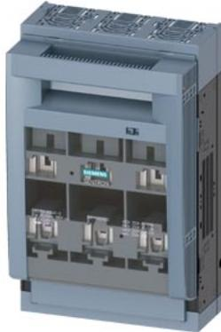
SETRON, sezionatore sottocarico a fusibili 3NP1, a 3 poli, NH1, 250 A, per montaggio e installazione su piastra di montaggio, morsetto serracavo, Livello di copertura 70mm
