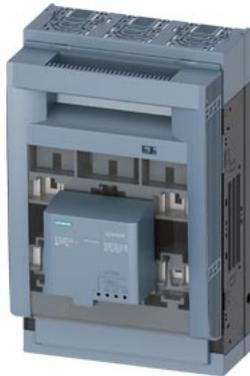
SETRON, sezionatore sottocarico a fusibili 3NP1, a 3 poli, NH1, 250 A, per montaggio e installazione su piastra di montaggio, attacco piatto, controllo fusibili: elettronico EFM10, livello di copertura 70mm
