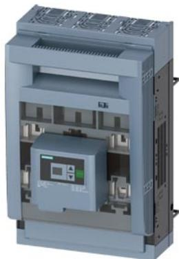
SETRON, sezionatore sottocarico a fusibili 3NP1, a 3 poli, NH1, 250 A, per Sistema di sbarre collettrici 8US 60mm, attacco piatto, controllo fusibili: elettronico EFM20, livello di copertura 32/70mm
