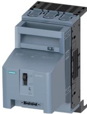
SETRON, sezionatore sottocarico a fusibili 3NP1, a 3 poli, NH00, 160 A, per Sistema di sbarre colletttrici Rittal 40mm, attacco piatto, controllo fusibili: elettromeccanico, livello di copertura 32/70mm
