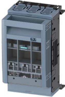
SETRON, sezionatore sottocarico a fusibili 3NP1, a 3 poli, NH00, 160 A, per Sistema di sbarre collettive 8US 60mm, attacco piatto, livello di copertura 32/70mm
