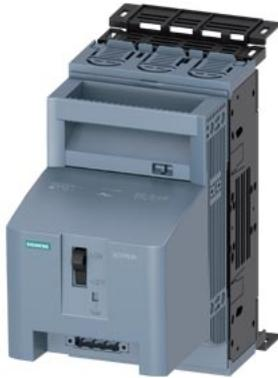
SETRON, sezionatore sottocarico a fusibili 3NP1, a 3 poli, NH00, 160 A, per Sistema di sbarre collettrici 8US 40mm, morsetto serracavo, controllo fusibili: elettromeccanico, livello di copertura 32/70mm
