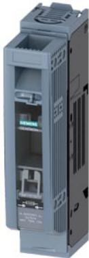
SENTRON, sezionatore sottocarico a fusibili 3NP1, a 1 polo, NH00, 160 A, per montaggio su piastra e in pannello su piastra di montaggio, attacchi piatti, livello di copertura 45 mm
