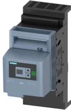
SETRON, sezionatore sottocarico a fusibili 3NP1, a 3 poli, NH000, 160 A, per sistema di sbarre collettive Rittal 40mm, morsetto serracavo, controllo fusibili: elettronico EFM20, livello di copertura 32/70mm
