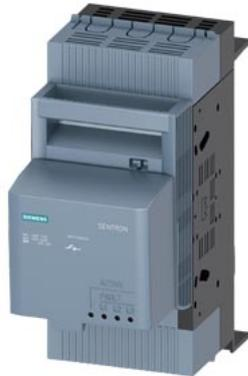
SETRON, sezionatore sottocarico a fusibili 3NP1, a 3 poli, NH000, 160 A, per sistema di sbarre collettive 8US 60 mm, morsetto serracavo, controllo fusibili, elettronico EFM15, livello di copertura 32/70 mm
