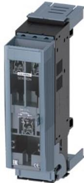
SETRON, sezionatore sottocarico a fusibili 3NP1, a 3 poli, grand. costr. NH000 stretta, 125 A, per sistema di sbarre collettrici 60 mm, morsetto serracavo, uscita cavo verso l'alto, livello di copertura 32/60/70mm
