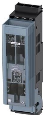
SETRON, sezionatore sottocarico a fusibili 3NP1, a 3 poli, NH000 stretta, 125 A, per montaggio e installazione su piastra di montaggio, morsetto serracavo, livello di copertura 45mm con blocchetto di contatti ausiliari 1CO
