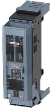
SETRON, sezionatore sottocarico a fusibili 3NP1, a 3 poli, grand. costr. NH000 stretta, 125 A, per sistema di sbarre collettive 60 mm, morsetto serracavo, uscita cavo verso il basso, con blocchetto di contatti ausiliari 1 CO livello di copertura 32/60/70mm
