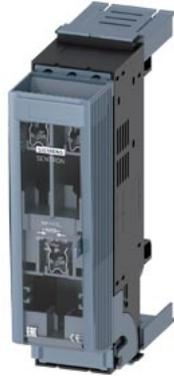
SETRON, sezionatore sottocarico a fusibili 3NP1, a 3 poli, grand. costr. NH000 stretta, 125 A, per sistema di sbarre collettive 60 mm, morsetto serracavo, uscita cavo verso il basso, livello di copertura 32/60/70mm
