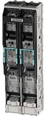
sezionatore sottocarico con fusibili a 3 poli sezionabile, per protezione di trasformatori lato secondario fino a 1000 kVA per fusibili NH GTR 2x722A max., AC 400 V, e coltelli sezionatori NH3 fino a 2000 A
