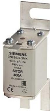
Cartuccia fusibile SITOR, con alette di fissaggio a vite, NH00, In: 400 A, aR, Un AC: 690 V, Un DC: 440 V, segnalatore di intervento frontale
