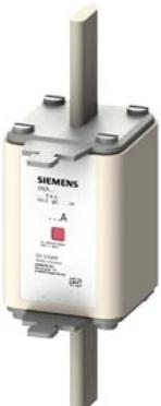
cartuccia fusibile NH, NH2, In: 100 A, gG, Un AC: 500 V, Un DC: 440 V, indicatore combinato, attacchi sotto tensione
