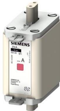
cartuccia fusibile NH, NH00, In: 50 A, gG, Un AC: 690 V, Un DC: 250 V, indicatore combinato, attacchi liberi da tensione
