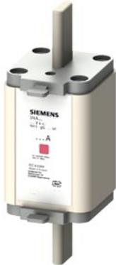
cartuccia fusibile NH, NH1, In: 200 A, gG, Un AC: 500 V, Un DC: 440 V, indicatore combinato, attacchi liberi da tensione
