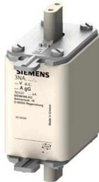
cartuccia fusibile NH, NH00, In: 100 A, gG, Un AC: 500 V, Un DC: 250 V, segnalatore di intervento frontale, attacchi sotto tensione
