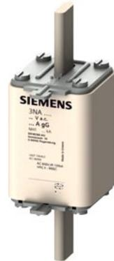
cartuccia fusibile NH, NH1, In: 250 A, gG, Un AC: 690 V, Un DC: 440 V, segnalatore di intervento frontale, attacchi sotto tensione
