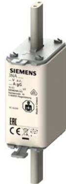
cartuccia fusibile NH, NH0, In: 125 A, gG, Un AC: 500 V, segnalatore di intervento frontale, attacchi sotto tensione
