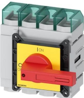
SENTRON, sezionatore sottocarico 3LD5 UL, interruttore di OFF di emergenza, a 4 poli, approvato secondo UL489, UL60947-4-1 e IEC60947-3, UL: 150 A, SCCR 50 kA con AC 480 V, potenza di impiego con AC 480 V trifase: 100 hp, IEC: 160 A potenza di impiego con AC-23A con 400 V: 75 kW, fissato frontalmente: comando rotativo, rosso/giallo, fissaggio a 4 fori dell'operatore, incl. calotte coprimorsetti per il lato alimentazione
