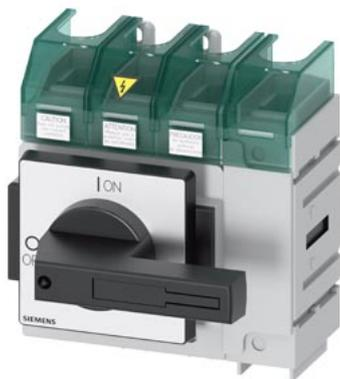
SETRON, sezionatore sottocarico 3LD5 UL, interruttore principale, a 4 poli, approvato secondo UL489, UL60947-4-1 e IEC60947-3, UL: 150 A, SCCR 50 kA con AC 480 V, potenza di impiego con AC 480 V trifase: 100 hp, IEC: 160 A potenza di impiego con AC-23A con 400 V: 75 kW, fissaggio su base con comando diretto, nero, include calotte coprimorsetti per il lato alimentazione
