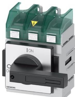
SENTRON, sezionatore sottocarico 3LD5 UL, interruttore principale, a 3 poli, approvato secondo UL489, UL60947-4-1 e IEC60947-3, UL: 150 A, SCCR 50 kA con AC 480 V, potenza di impiego con AC 480 V trifase: 100 hp, IEC: 160 A potenza di impiego con AC-23A con 400 V: 75 kW, fissaggio su base con comando diretto, nero, incluse calotte coprimorsetti per il lato alimentazione
