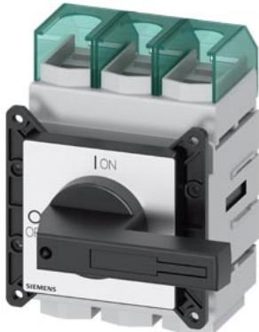
SENTRON, sezionatore sottocarico 3LD5 UL, interruttore principale, a 3 poli, approvato secondo UL489, UL60947-4-1 e IEC60947-3, UL: 125 A, SCCR 65 kA con AC 480 V, potenza di impiego con AC 480 V trifase: 75 hp, IEC: 125 A, potenza di impiego con AC-23A con 400 V: 55 kW, fissato frontalmente: comando rotativo, nero, fissaggio a 4 fori dell'operatore, incl. calotte coprimorsetti per il lato alimentazione
