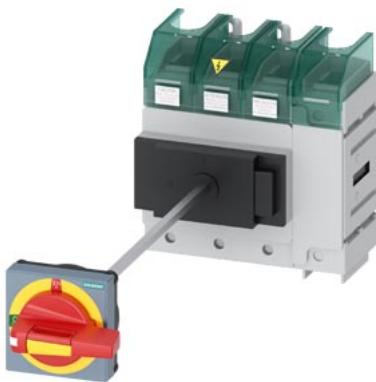
SENTRON, sezionatore sottocarico 3LD5 UL, interruttore di OFF di emergenza, a 4 poli, approvato secondo UL489, UL60947-4-1 e IEC60947-3, UL: 125 A, SCCR 65 kA con AC 480 V, potenza di impiego con AC 480 V trifase: 75 hp, IEC: 125 A, potenza di impiego con AC-23A con 400 V: 55 kW, fissaggio su base con bloccoporta, aggirabile comando rotativo, OFF di emergenza, 4 fori per fissaggio dell'operatore, senza compensazione della tolleranza incluse calotte coprimorsetti per il lato alimentazione
