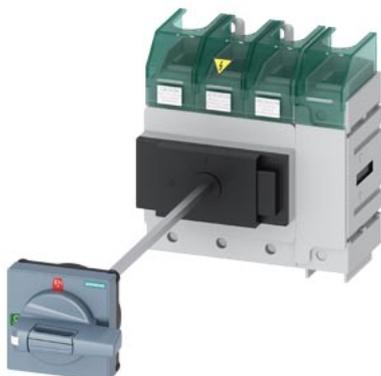
SETRON, sezionatore sottocarico 3LD5 UL, interruttore principale, a 4 poli, approvato secondo UL489, UL60947-4-1 e IEC60947-3, UL: 125 A, SCCR 65 kA con AC 480 V, potenza di impiego con AC 480 V trifase: 75 hp, IEC: 125 A, potenza di impiego con AC-23A con 400 V: 55 kW, fissaggio su base con bloccoporta, aggirabile comando rotativo, standard, 4 fori per fissaggio dell'operatore, senza compensazione della tolleranza, incluse calotte coprimorsetti per il lato alimentazione
