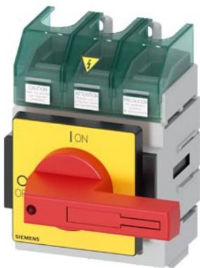
SENTRON, sezionatore sottocarico 3LD5 UL, interruttore di OFF di emergenza, a 3 poli, approvato secondo UL489, UL60947-4-1 e IEC60947-3, UL: 125 A, SCCR 65 kA con AC 480 V, potenza di impiego con AC 480 V trifase: 75 hp, IEC: 125 A, potenza di impiego con AC-23A con 400 V: 55 kW, fissaggio su base con comando diretto, rosso/giallo incluse calotte coprimorsetti per il lato alimentazione
