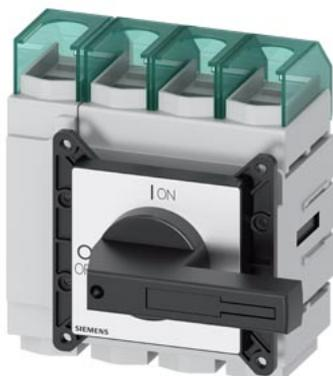
SENTRON, sezionatore sottocarico 3LD5 UL, interruttore principale, a 4 poli, approvato secondo UL489, UL60947-4-1 e IEC60947-3, UL: 100 A, SCCR 65 kA con AC 480 V, potenza di impiego con AC 480 V trifase: 60 hp, IEC: 100 A, potenza di impiego con AC-23A con 400 V: 45 kW, fissato frontalmente: comando rotativo, nero, fissaggio a 4 fori dell'operatore, incl. calotte coprimerse per il lato alimentazione
